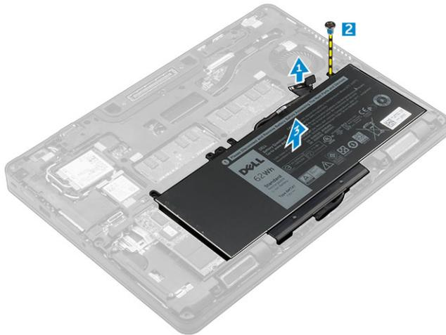
4. Remova o cabo do canal de roteamento [1] e remova o cabo da bateria [2].
